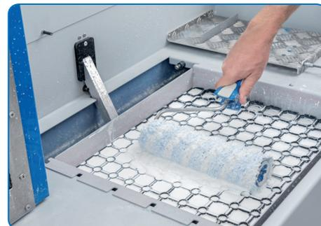
**4** Poste de prélavage des rouleaux : prélevés, les rouleaux seront nettoyés encore plus vite dans le TurboWash, ce qui entraîne également des économies d'eau.
